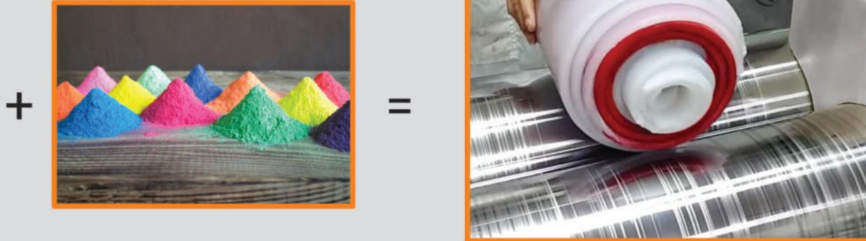
کامپاند سیلیکونی چیست؟ کامپاندهای سیلیکونی HTV جامد مورد استفاده در عایق و روکش سیم و کابل ها از ترکیب چند جزء تشکیل می شوند. که شامل سیلیکون + پودرها (جهت بهبود برخی خواص و شرایط سیلیکون) + رنگدانه ها + تثبیت کننده ها می باشند. کامپاندها بر مبنای استانداردهای موجود و مورد درخواست مشتری فرمول دهی و ترکیب می شوند.
